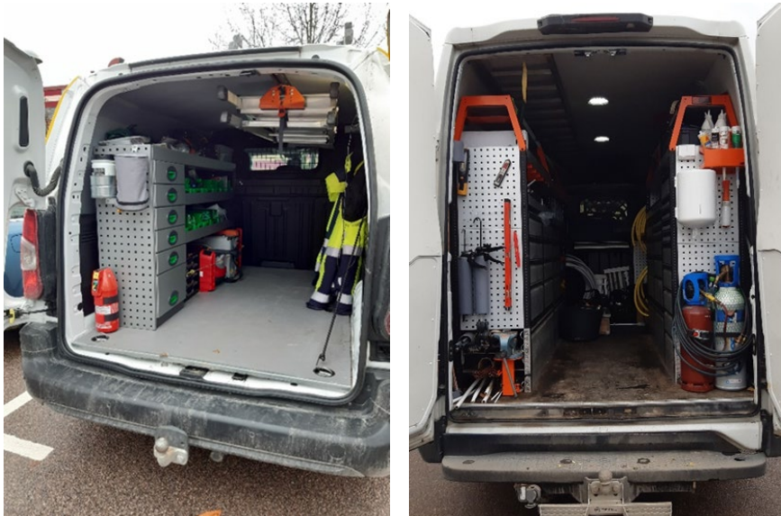
Figur 5 Fordon med hyllor på ena sidan eller båda sidorna.
